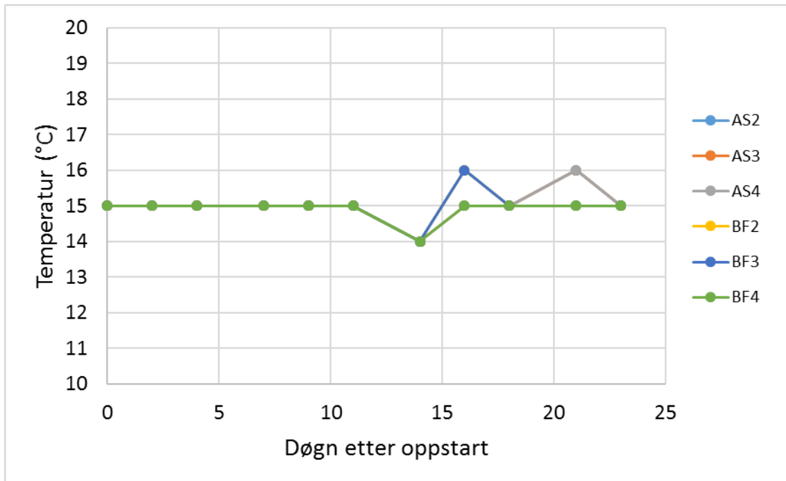
Figur 37: Temperaturen målt i klarvannsprøvene fra reaktorene AS2, AS3 og AS4 (aktivslam) og BF2, BF3 og BF4 (MBBR) gjennom oppstartsperioden da reaktorene fikk tilsatt avløpsvann (4 uker). Temperaturen ble målt rett etter at prøvene ble tatt ut fra reaktorene. Ved de aller fleste målingene var temperaturen i de ulike prøvene den samme, og derfor synes kun én farge i grafen.
